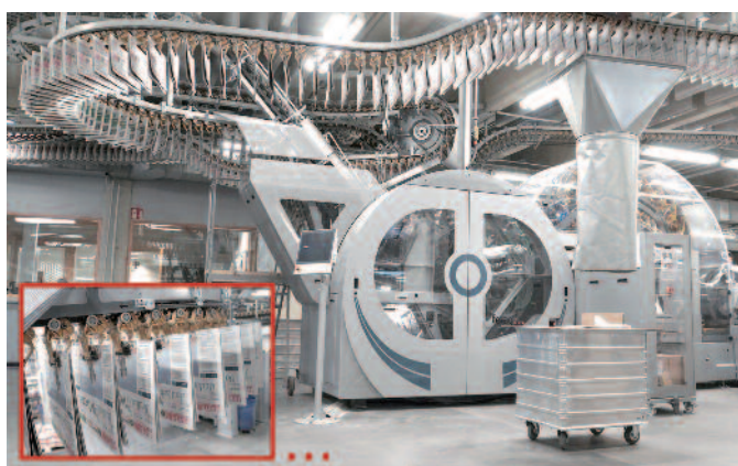
Nach dem von Ferag entwickelten Konzept können alle von Badendruck eingesetzten Kreuzleger beliebig den Versandraumstrecken zugewiesen werden. Um ein Höchstmass an Flexibilität zu erreichen, wurden die bisher für den Abtransport eingesetzten PKT-Strecken zu einer «Acht» verbunden.
