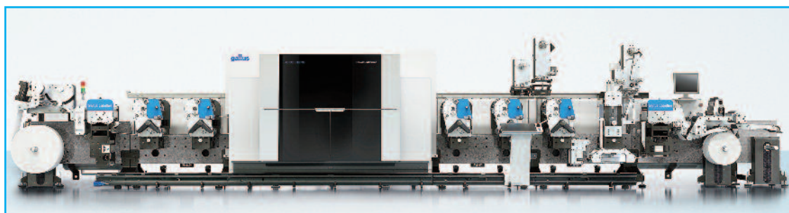
Die Gallus Labelfire ist eine typische Hybrid-Maschine, deren Krenz zwar eine digitale Druckeinheit in der Maschinenmitte ist, die jedoch um Flexodruckwerke und Finishing-Optionen erweitert werden kann.
