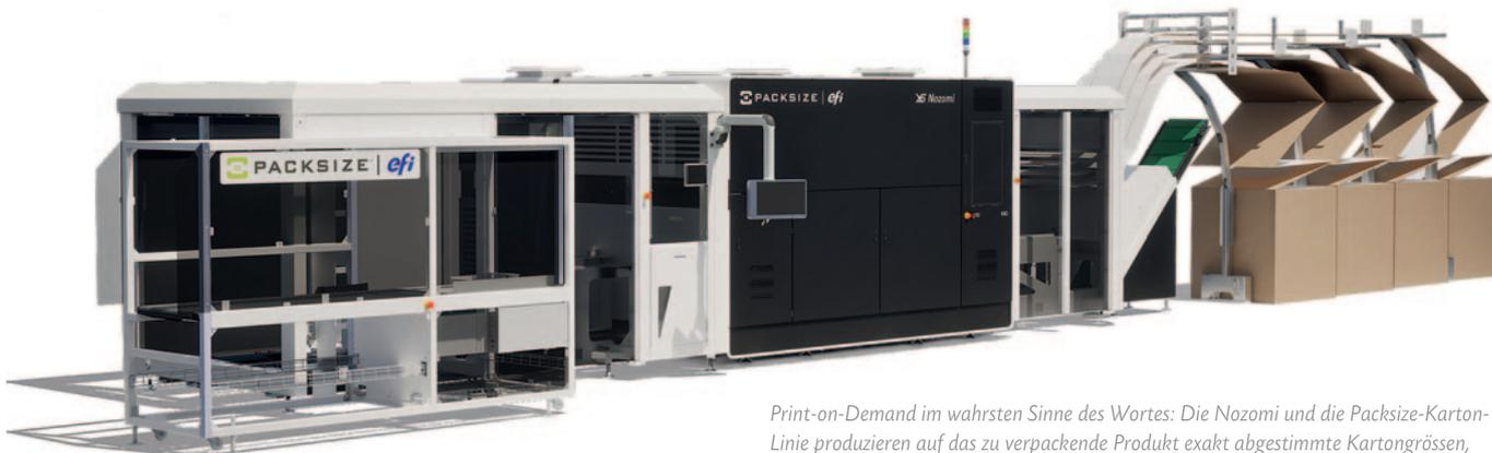
Print-on-Demand im wahrsten Sinne des Wortes: Die Nozomi und die Packsize-Karton-Linie produzieren auf das zu verpackende Produkt exakt abgestimmte Kartongrößen, bedrucken, schneiden, falzen, kleben und richten diese auf.
