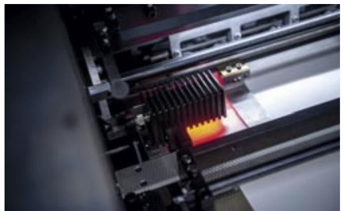
DriveTronic SIS : Die ziehmarkenfreie Anlage bietet gerade bei hohen Produktionsleistungen genügend Zeit für die exakte Positionierung der Bogen an der Anlage.
