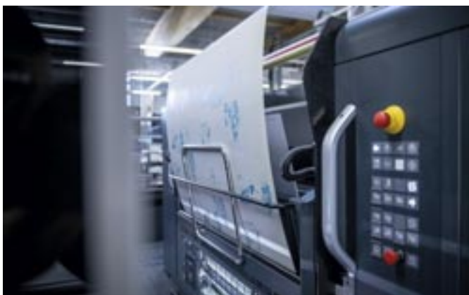
Der simultane Druckplattenwechsel DriveTronic SPC gehört schon seit Jahren zum inoffiziellen Standard an Akzidenzmaschinen für den Schön- und Widerdruck. Er bietet kurze Plattenwechselzeiten und macht die Produktion von kleinen Auflagen wirtschaftlich.
