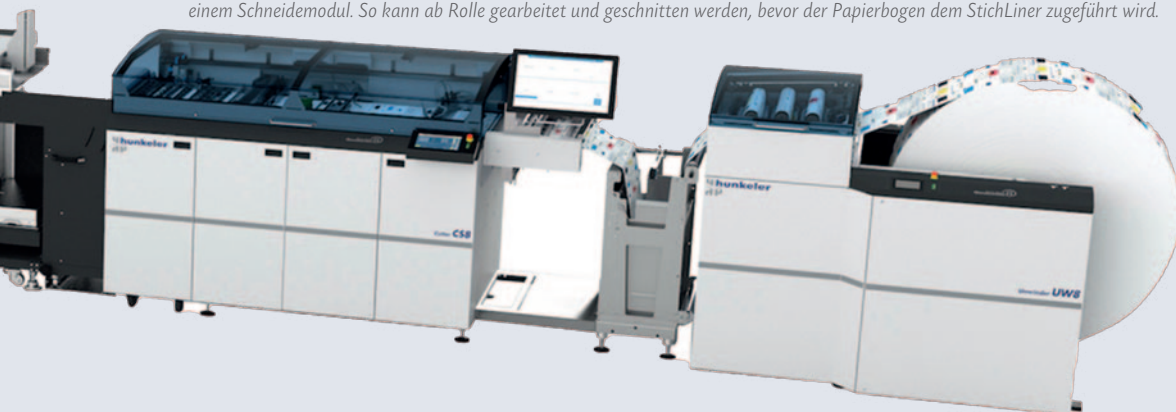
Der StichLinerMark V ist zudem ausgelegt auf Inline- oder Nearline-Produktionsabläufe. Hier beispielsweise eine Konfiguration mit einem Hunkeler Abroller und einem Schneidemodul. So kann ab Rolle gearbeitet und geschnitten werden, bevor der Papierbogen dem StichLiner zugeführt wird.
