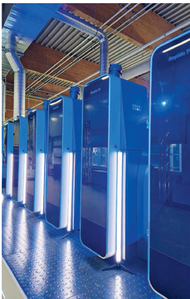
Die Rapida 76 bewies beim Open House ihre Flexibilität für den Akzidenz-, Label- und Verpackungsdruck – basierend auf der Technologie-Plattform der Mittelformat-Maschine Rapida 106 . Installiert ist im Koenig & Bauer Kundenzentrum eine Siebenfarben- Rapida 76 für das maximale Bogenformat 605 x 750 mm.
