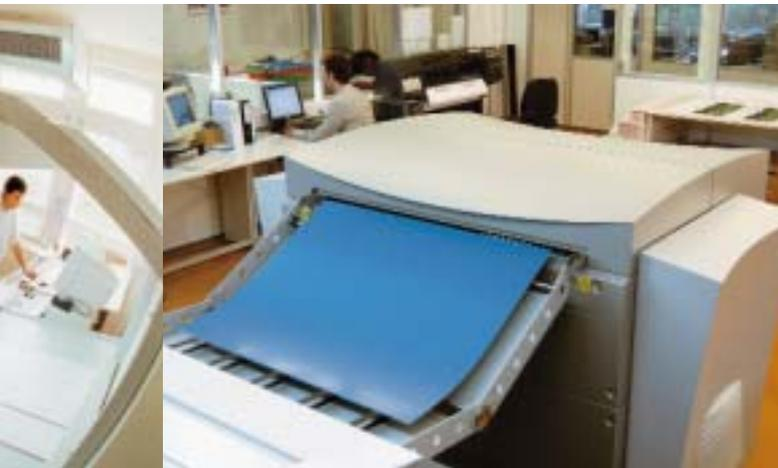
vollautomatischen Thermoplattenbelichters vom Typ Lotem 800 Quantum mit Online-Plattenentwicklung. Im Drucksaal der Neidhart + Schön AG herrscht das Maschinenformat 3B vor. Leistungsträger sind hier eine Sieben- und eine Fünffarben-Roland 700. Für die JDF-basierende Vernetzung der beiden Bogenoffsetmaschinen im 3B-Format war kein Hardware-Upgrade, sondern lediglich eine Softwareaktualisierung des PECOM-Systems erforderlich.
