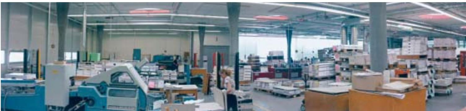
Mit einer Tageskapazität von bis zu 15.000 Büchern ist BUBU eine der größten Buchbindereien im deutschsprachigen Raum. Fünf Fadenheftmaschinen modernster Bauart und eine vollelektronisch gesteuerte Deckenmachmaschine sind wesentliche Produktionsstützen der Buchproduktion. Die Hardcover-Linie mit der Buchstraße von VBF misst 84 m vom Blockanleger bis zum Umlegen des Umschlages und dem Folienverschweißen. Softcover werden mit der Broschürenstraße Acoro von Müller Martini hergestellt.
