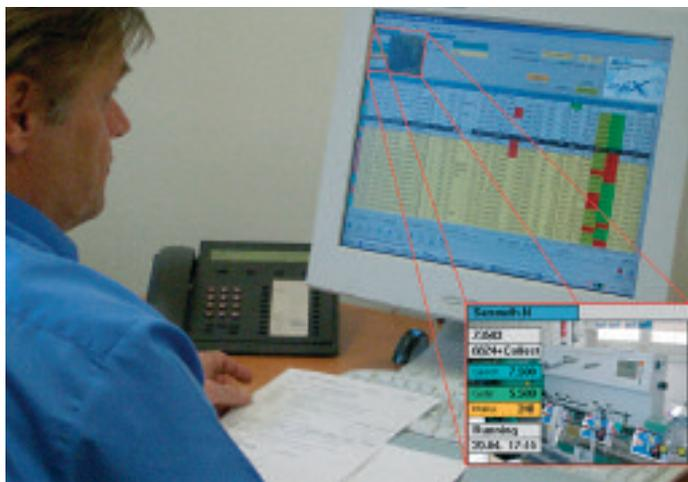
Am Monitor wird die Planung der Auftragsreihenfolge in der Hiflex-Disposition angezeigt, die zugleich als JDF-Controller fungiert. In der oberen linken Ecke werden die Maschineninformationen angezeigt, die via JDF/JMF vom Müller Martini Sammelhefter empfangen werden.
