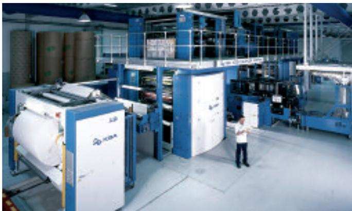
Ein zweites Falzwerk wurde bereits bestellt und soll im Herbst 2005 in Produktion gehen, um Produkte mit geringeren Seitenzahlen parallel produzieren und damit auch große Aufträge termingerecht bewältigen zu können. Die Steuerung der Rotation erfolgt über zwei KBA-Leitstände mit Online-Fernwartung.
