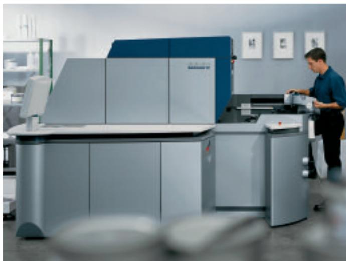
Das farbzonenlose Farbwerk Anicolor feiert in einer Speedmaster SM 52-Vierfarbenmaschine Premiere. Das Farbwerk hat weniger Walzen als ein konventionelles Werk. Dadurch erfolgt eine sehr schnelle Einfärbung und es werden extrem wenige Anlaufbögen benötigt – je nach Drucksujet nur 10 bis 20 Bögen.
