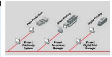
Vorstufe, Drucksaal und Digitaldruck können nunmehr über ein einziges integriertes System gesteuert werden und mit dem Management Informations System kommunizieren.
