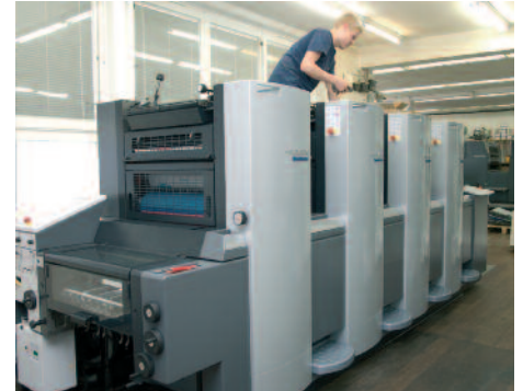
Die neue Speedmaster SM 52-4. Im Hintergrund steht die Speedmaster SM 74-4, deren CP2000-Leitstand mit dem Prinect Prepress Interface nachgerüstet wurde.
