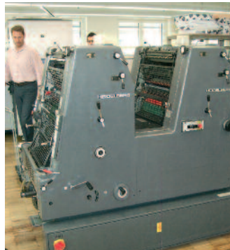
Eine ausgebaute Zweifarben-Maschine wurde bei der DAZ zur «Primer-Maschine» umgebaut, um Bedruckstoffe zu konfektionieren. Das «Primen» bietet DAZ auch als Dienstleistung an.
