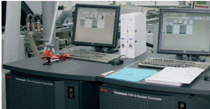
Über Kodak Versamark CS410 Systemcontroller werden die Prosper S10 Systeme in der Mailinganlage gesteuert und mit Druckdaten versorgt.
