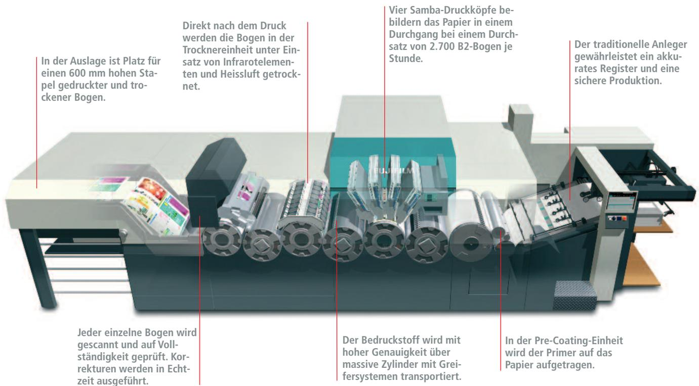
In der Auslage ist Platz für einen 600 mm hohen Stapel gedruckter und trockener Bogen.
