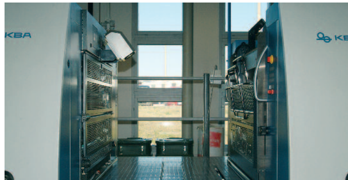
Die Scan-Kamera an einem der Drucktürme ist Teil von QualiTronic Color-Control, dem Inlinefarbmess- und Regelungssystem.
