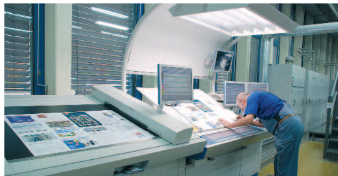
Beim Einrichten werden die Daten von der Vorstufe für die Voreinstellung übernommen. Bereits beim ersten Bogen übernimmt QualiTronic ColorControl die Messdaten für den Soll-Ist-Vergleich.
