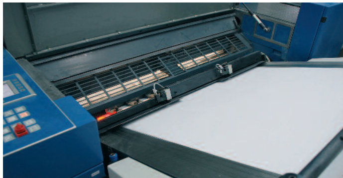
Die ziehmarkenfreie Drive Tronic SideLay SIS-Anlage bietet eine hohe Ausrichtgenauigkeit durch die langen Ruhepausen an der Anlegelinie.
