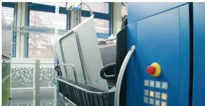
Mit dem Einzelantrieb laufen Plattenwechsel und Waschvorgänge nicht sequenziell ab, sondern dank der speziellen Auskuppelungsfunktion parallel. Das reduziert die Umrüst- und Rüstzeiten sehr deutlich.
