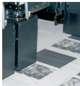
Inkjet-Druckköpfe von Kodak kommen auch bei der T-Press von Timsons zum Einsatz.
