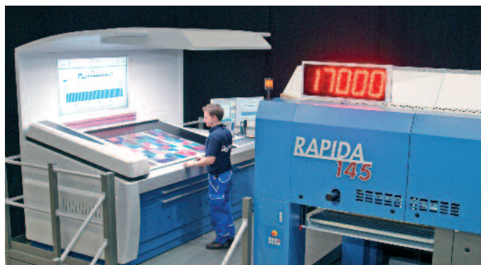
Mit der Rapida 145 stellt KBA auf der drupa seine neue Grossformatgeneration vor, die mit 17.000 Bg/h. produziert, und bei der viele technischen Merkmale von der Rapida 106 übernommen wurden.
