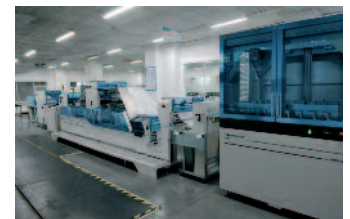
Die Digital Book Solution produziert Buchblocks mit 4-, 6- oder 8-seitigen Signaturen im Nonstop-Betrieb, bei Leistungen von 200 m/Min.
