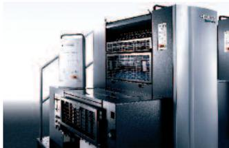
trieb gehenden Maschine handelt es sich um modular konfigurierbare Bogenoffsettechnik. Die neue Baureihe vereint Merkmale der XL-Technologie mit der Plattform der Speedmaster SM 74. Nach Aussagen der beiden Inhaberinnen waren der für diese Maschinenklasse hohe Automationsgrad und der geringe Energiebedarf entscheidende Faktoren für den Kauf. Gepaart mit der Fortdruckleistung von 15.000 Bg/h will die Victoriadruck AG bis in kleinste Auflagenbereiche einen spürbaren Produktivitätsgewinn erreichen.
