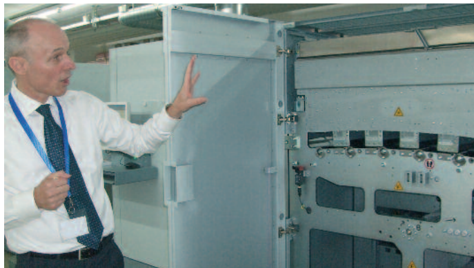
Die Druckeinheit der Océ ColorStream 3700 wirkt sehr aufgeräumt. Mit der Twin-Konfiguration und ihrer Leistung von 100 m/Min. lassen sich rund 80.000 vierfarbigen A4-Seiten pro Stunde produzieren.
