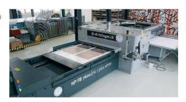
Der zum HP FB7600 aufgerüstete Flachbettdrucker produziert bis zu 500 m² starre Platten und flexible Materialien in einer Auflösung bis zu 600 dpi. Bei einem maximalen Druckformat von 1.600 mm x 3.200 mm kann die maximale Materialstärke bis zu 25 mm betragen. Dafür stehen sechs Farben (CMYK, Cyan Light und Magenta Light) plus Weiss zur Verfügung.
