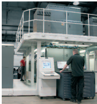
Hier hat der Digitaldruck industrielle Dimensionen angenommen: Inkjet-Druckköpfe von Kodak in der T-Press von Timsons.
