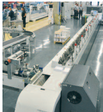
Der Heidelberg-Klebbinder Eurobind Pro kann mit einer Buchproduktionslinie von Hunkeler kombiniert werden.
