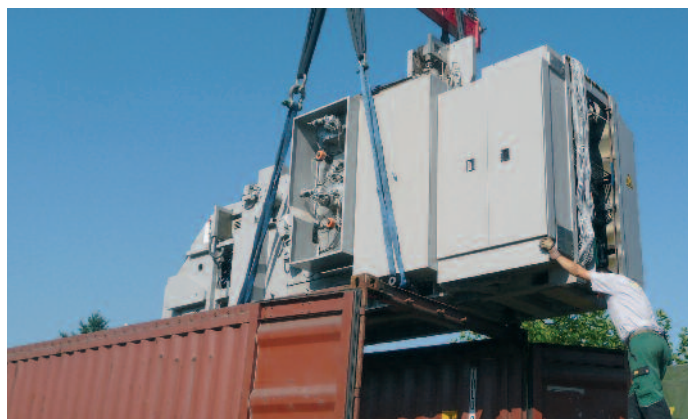
Die Baugruppen werden möglichst zusammenhängend in Transportkisten und Container verstaut. Dabei bringt es alleine der Falzapparat auf rund 18 Tonnen.
