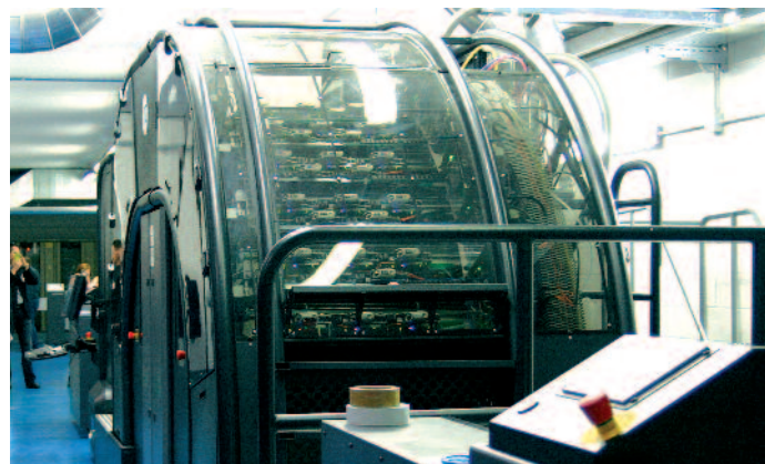
Seit Januar ergänzt eine HP T230 die Produktionskapazitäten. Damit werden ebenfalls Tageszeitungen, aber auch Magazin-Cover hergestellt.
