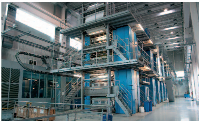
Vier Wifag-Offsetdrucklinien produzieren bei CQS täglich 370.000 Tageszeitungen für die lombardische Region.
