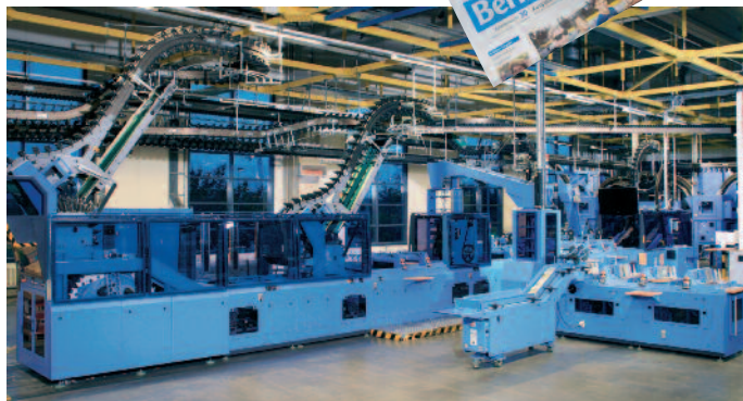
Ein starkes Duo für den Versandraum: Die in 33 Lokalausgaben erscheinende «Berliner Woche» mit 1,53 Mio. Exemplaren wird über das Zeitungs-Einstecksystem ProLiner mit Vorsammler CoLiner von Müller Martini verarbeitet.
