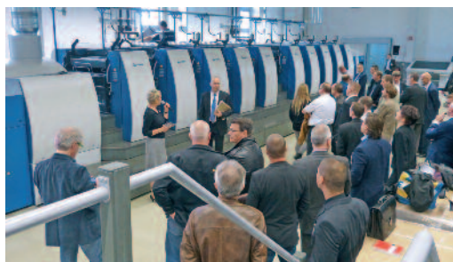
Interessiert verfolgen die Besucher die Druckproduktion mit simultanem Plattenwechsel an einer Rapida 10.
