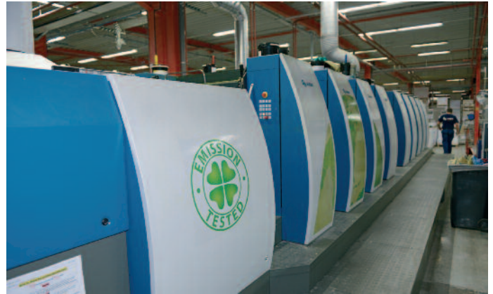
Bei Albe de Coker ging 2013 weltweit die erste Achtefarben-Rapida-106 mit HR-UV-Trocknern in Betrieb.
