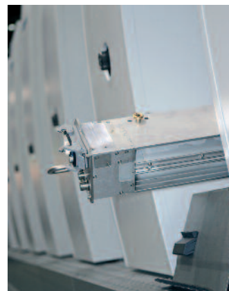
Ein HR-UV-Trockner reicht, um bis zu fünf nass in nass gedruckte, hochreaktive Farben zu trocknen.
