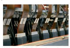
duktivität durch die überlappend angeordneten 20 Ricoh-Inkjet-Druckköpfe.
