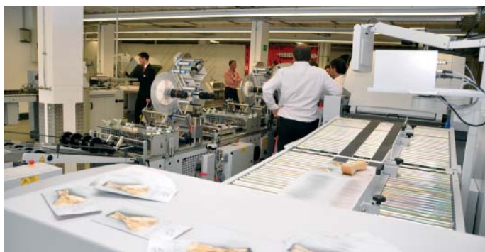
Für die industrielle Hochleistungsproduktion bietet die Stahlfolder TX 82 Falzanlage höchste Produktivität. Es sind Leistungssteigerungen von bis zu 50% gegenüber konventionellen Produktionsarten möglich.
