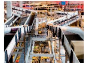
Etappe im Paketzentrum Härkingen eine noch leistungsfähigere Sortieranlage in Betrieb genommen. Die Förder- und Sortieranlage wurde bei laufendem Betrieb über den drei bestehenden Sortern in sechs Metern Höhe installiert und mit ihnen verbunden. Mit 2,5 m/Sek. läuft die neue Anlage schneller als die bestehenden Systeme, deren Leistung bei 1,7 m/Sek. liegt. Insgesamt investierte die Post rund 20 Mio. Franken in den Ausbau im Paketzentrum Härkingen.
