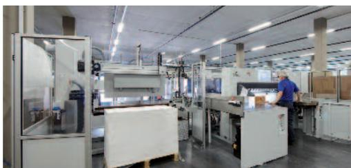
Auf der Polar N 137 Pro sichert die Belade- und Entladevorrichtung Transomat den zügigen Produktionsfluss. Wichtige Komponente für den benutzerfreundlichen Arbeitsprozess: die Hintertischbeschickung der Polar N 137 Pro.
