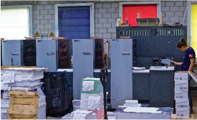
Auf beiden Speedmaster-Maschinen wird bei der Druckerei Lutz AG wasserlos gedruckt.
