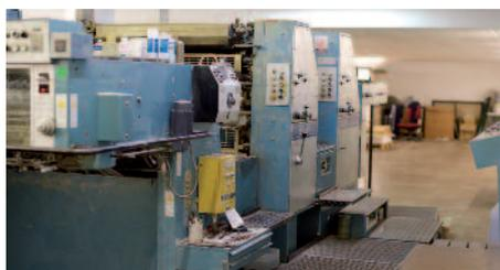
Auf einer Offsetmaschine älteren Baujahrs bringt Wolfensberger die Unterdruckfarbe auf. In der
