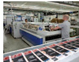
Ein Merkmal der neuen Wohlenberg-Klebebindelinie ist die Herstellung von Klappenbroschüren in nur einem Durchgang. Im Bild die Klappenstation.
