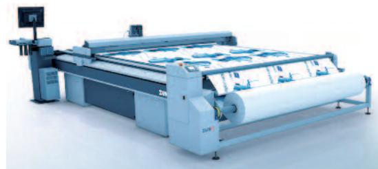
Ausgerüstet mit einem Zentrumschwicker schneidet der Zünd Cutter G3 3XL-1600 Rollenmaterialien bis zu einer Breite von 3,21 m vollautomatisch und wirtschaftlich.
