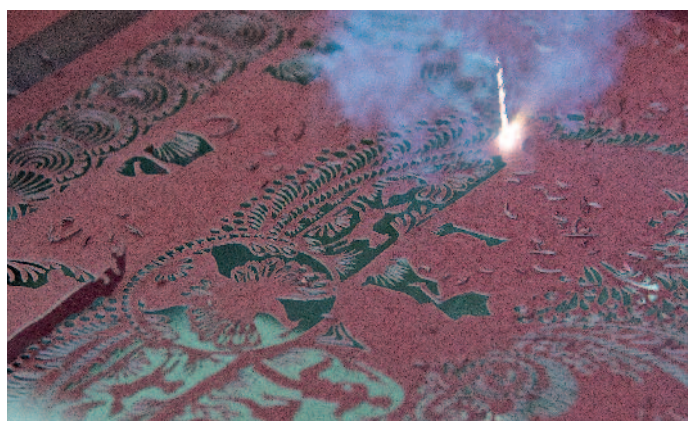
Eine der vielen Spezialitäten bei der Bruno Sonderegger AG ist das Laserschneiden, bei dem die filigranen Formen aus dem Material herausgebrannt werden.
