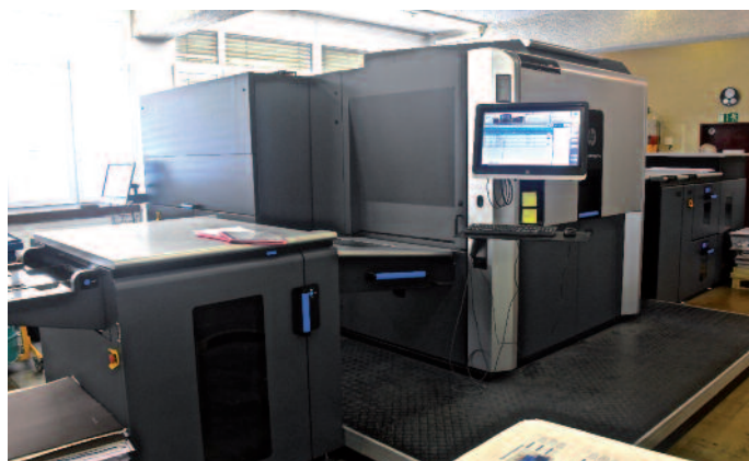
Seit einigen Wochen produziert bei der Kasimir Meyer AG in Wohlen eine HP Indigo 10000 mit sieben Farben im Format 53 x 75 cm und ergänzt die bisherige Konfiguration aus Indigo 5600 und Scodix S75.
