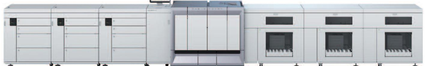
Bedrucken von Papieren mit einem Flächengewicht von 45 g/m<sup>2</sup> bis zum Format 350 x 500 mm möglich ist. Das erlaubt Anwendungen wie den Druck von Büchern auf Dünndruckpapier, Fachinformationen, mehrsprachige Produktbeileger sowie Beipackzettel.
