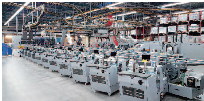
20 JetFeeder-Anleger je Linie haben bei der Chemnitzer Verlag und Druck GmbH die Einsteckkapazitäten deutlich erhöht.
