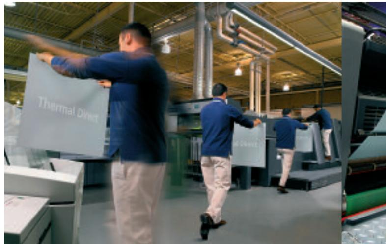
**Bebildern, einspannen und wie gewohnt mit dem Druck beginnen: prozesslose Platten reduzieren die Arbeitsschritte bis zur Auflagenproduktion deutlich. Für die Drucker macht es keinen Unterschied: Die Kodak Thermal Direct lässt sich handhaben wie eine normale Aluminium-Offsetdruckplatte.**
