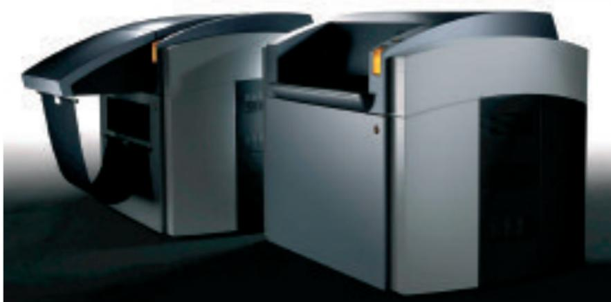
Die in der Standardversion manuell zu bedienenden Geräte, lassen sich optional zu einem Vollautomaten ausbauen und werden in dieser Kombination zum platzsparendsten Gerät ihrer Klasse. Dafür wird der Auto-Top-Loader-Aufsatz (ATL) auf das Basisgerät installiert (in der Abbildung links). Die Kassetten fassen je nach Plattenstärke zwischen 50 und 100 Platten.
