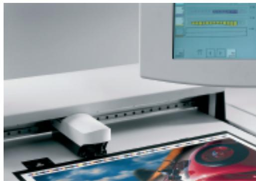
Princt Axis Control ist in das Steuerpult Princt CP2000 Center der Druckmaschine integriert und misst spektralfotometrisch im Farbsstreifen.
