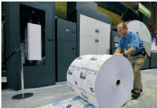
Das 914-mm-Hochgeschwindigkeits-Drucksystem HP Inkjet Web Press war eine der Überraschungen der drupa. HP hatte im Vorfeld eine 762 mm breite Version angekündigt. Die Maschine geht nun in den Betatest.
