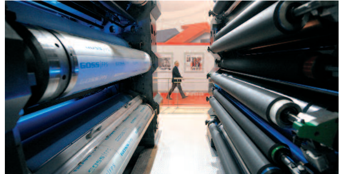
»New Ways for Print« versprach Goss und zeigte neben seinen Rotationen eine Alternative zu traditionellen Bogenmaschinen: das System basiert auf einer Rotationsmaschine und ist mit einem Querschneider ausgestattet.
