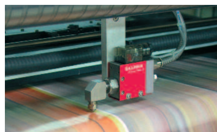
Mit WebTack präsentiert Baldwin für den Akzidenzenrollenoffsetdruck ein Längsleimsystem.
