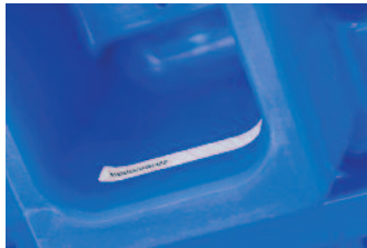
Palette mit TAG (elastischer RFID-Datenträger) vom Typ Simatic RF630L.
