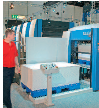
Der Stapelwender auf der drupa war mit einem RFID-Schreib- und Lesegerät ausgestattet.
