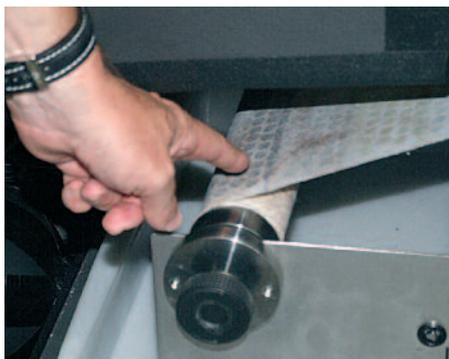
Die Filtermatte in der Feuchtmittelaufbereitung bietet hohe Konstanz und zugleich ein einfaches Handling.
