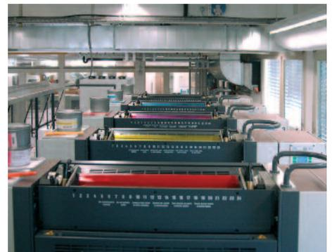
Farbwerke der neuen Roland 505: eine Fünf-farbedruckmaschine plus Lackwerk, verlängerte Auslage mit IR-Trocknung.
