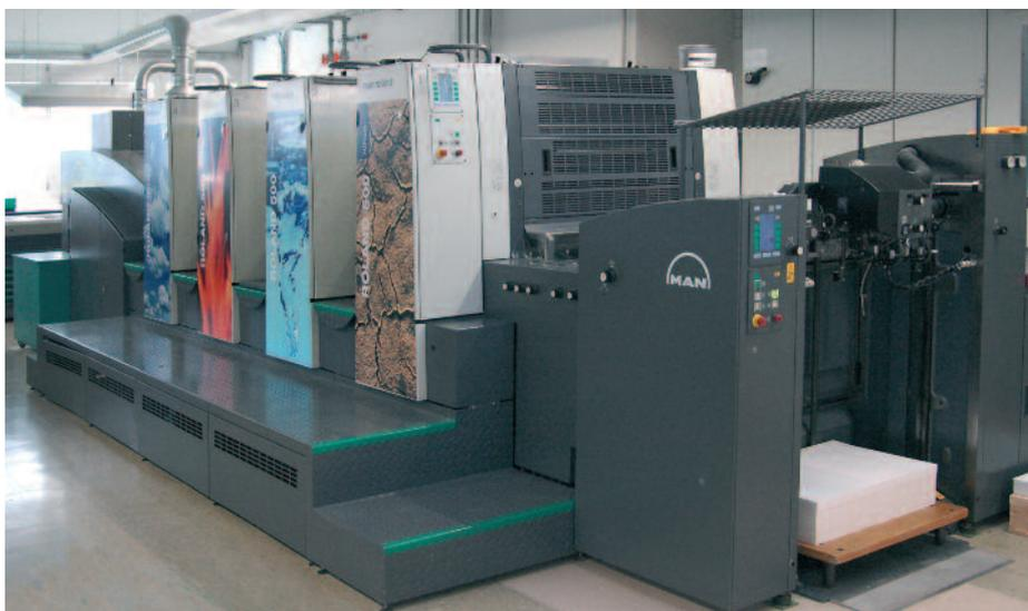
**Neue Vierfarbendruckmaschine Roland 504, mit einer Bogenwendung in der Mitte.**
