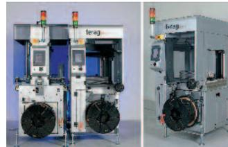
30 und 36 Paketen pro Minute. Beide können für Querumreifung, Längsumreifung oder für die Inline-Kreuzumreifung ohne Drehtisch konfiguriert werden. Mit einer links- und rechtsseitigen Ausführung lassen sich die Bindemaschinen in jede Verarbeitungslinie integrieren. [www.ferag.com](http://www.ferag.com)
