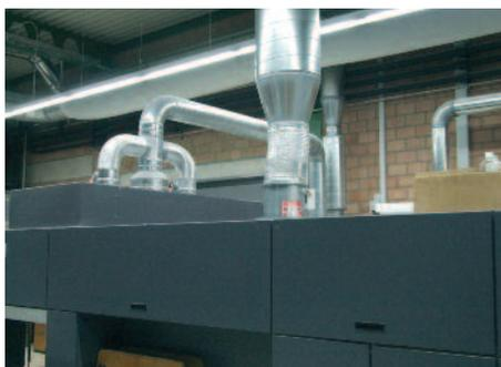
**Wärmerückgewinnung und Puderabsaugung an der Druckmaschine – ideales Klima im Drucksaal.**
